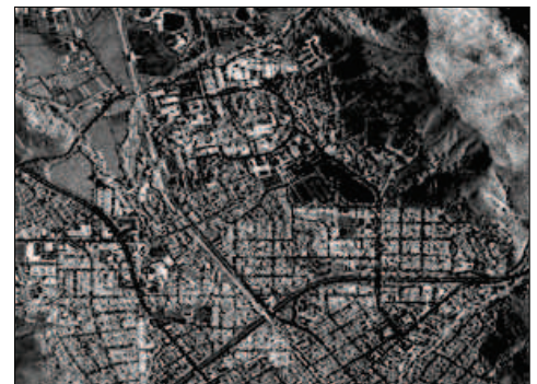
Orthorektifizierte Radarbilder Auflösung: 1,25m Horizontale Genauigkeit: 4m CE90%
